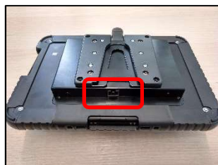
Abbildung 4: Tablet Rückansicht mit Anschluss für Datenkabel
