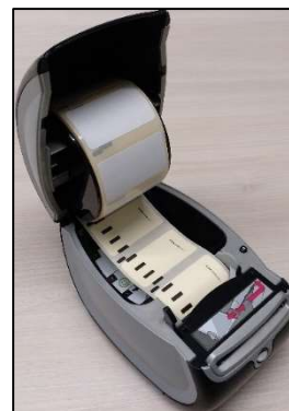
Abbildung 23: Geöffneter Etikettendrucker mit Etikettenrolle
