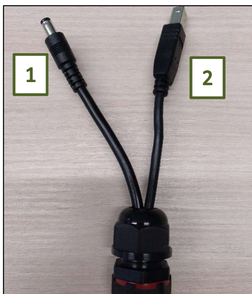
Abbildung 20: Druckerkabel mit Y-Stück
