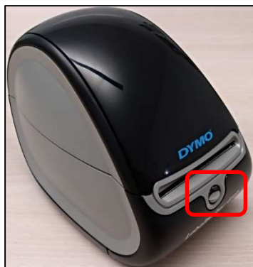
Abbildung 22: Etikettendrucker mit Taster
